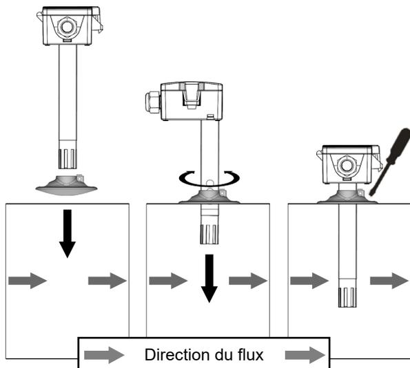
Ne penchez pas le capteur pendant le montage / démontage !
