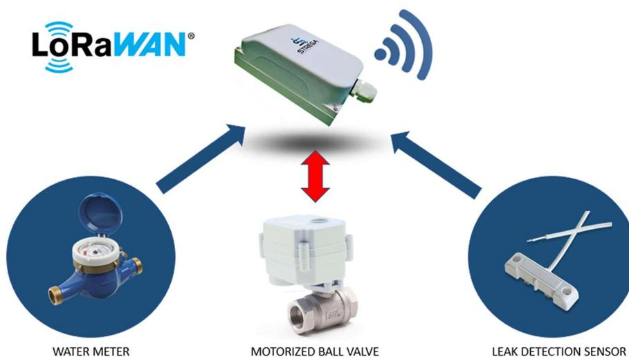
L'électrovanne motorisée STREGA est une vanne sans fil fonctionnant sur batterie avec technologie LoRaWAN® embarquée. Avec sa consommation d'énergie ultra-faible, la vanne connectée peut être déclenchée pour des opérations d'OUVERTURE/FERMETURE à distance, complète ou partielle. La vanne fonctionne sur piles pendant plus de 10 ans (Classe A) ou sans limite sur alimentation externe (Classe C). Des opérations intelligentes automatiques peuvent être programmées sur tout changement d'état d'E/S.
