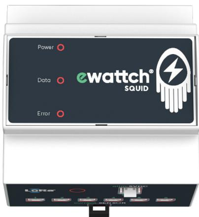
Le capteur LoRaWAN permettant de réaliser le sous comptage électrique des installations monophasées ou triphasées. Équipé de 12 pinces de mesure de courant, il envoie les valeurs de courant mesurées par l'intermédiaire d'une liaison sans-fil LoRaWAN.
