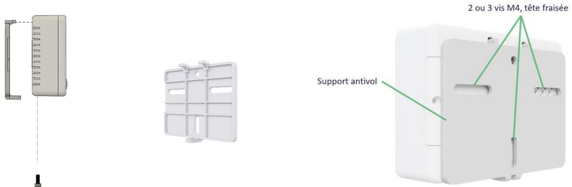
*A gauche : Le système antivol est fixé grâce à la station via une vis M4. A droite : fixé au mur via deux ou trois vis M4, tête fraisée.*
