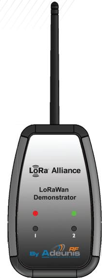
Le démonstrateur **LoRa by ADEUNIS RF** est un système prêt à l'emploi permettant de se connecter à tous les réseaux utilisant le protocole **LoRaWAN**.
