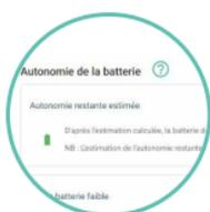
A travers la page capteur vous pourrez observer l'autonomie restante estimée par KARE. En effet cette estimation est réalisée par un algorithme de calcul basé principalement sur l'analyse du fonctionnement radio du produit depuis sa déclaration (date de mise en service renseignée lors de la déclaration du capteur sur KARE), du nombre d'uplinks et nombre de downlinks et extrapolée dans le futur.
