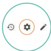
L'icône « écrou » en haut à droite de la page d'un capteur permet d'accéder à la configuration du capteur.
