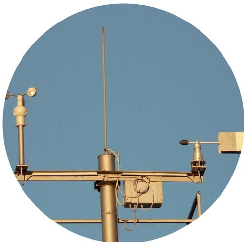
Rendre communicantes des stations météo équipées de multiples capteurs.
